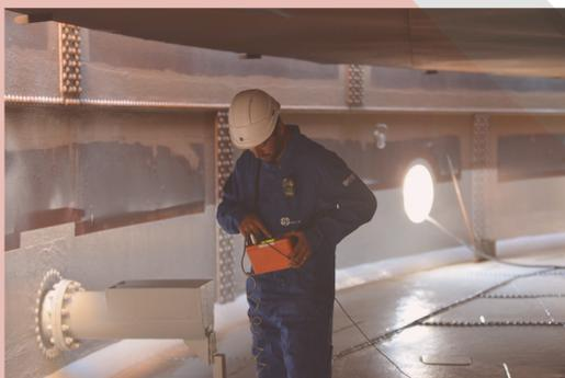
Grâce à un appareil, le microtest, nous mesurons l'épaisseur de revêtement déposé. Cette vérification est réalisée entre chaque couche de produit du système appliqué. Un outil complémentaire, le peigne de contrôle de porosité, permet de procéder à des inspections sur l'ensemble de la surface traitée pour détecter toute absence de peinture éventuelle avant la réception.
